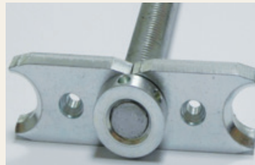
Gewindestange oder Passbolzen um 1,0 mm je Seite kürzer als Planmaß (darf nicht über Einhängemutter überstehen)
