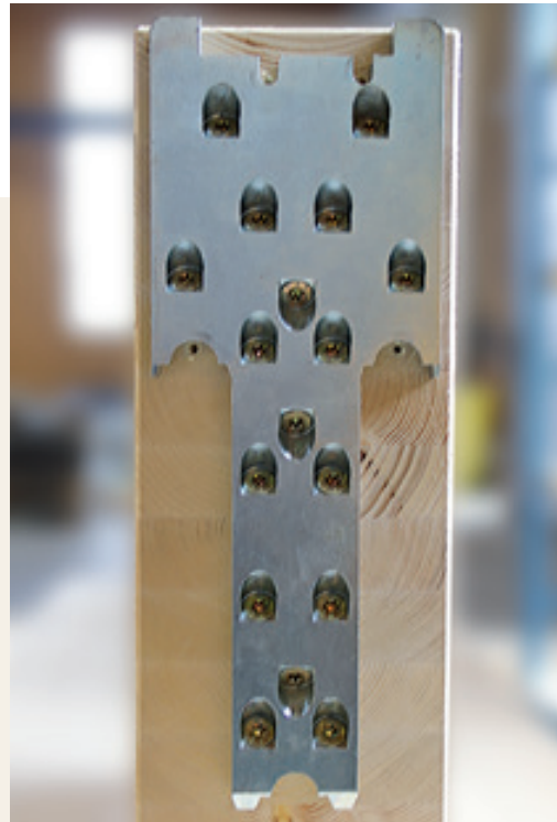
Balkenträger Grundelement 2: WHB 150-260 ( V_k \leq 260 kN)
