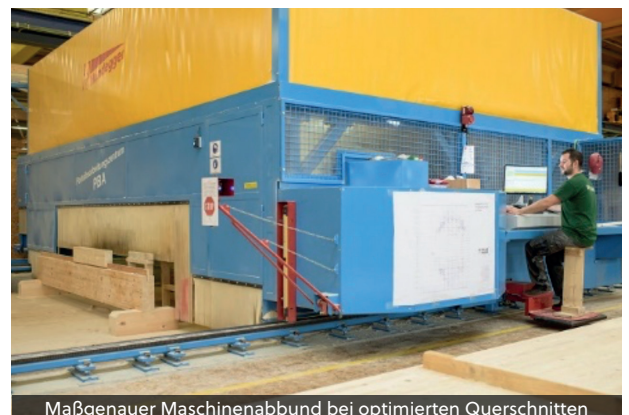
Maßgenauer Maschinenabbund bei optimierten Querschnitten
