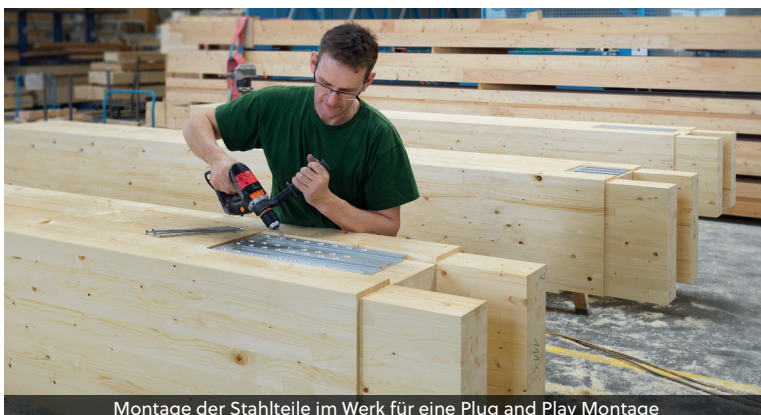
Montage der Stahlteile im Werk für eine Plug and Play Montage
